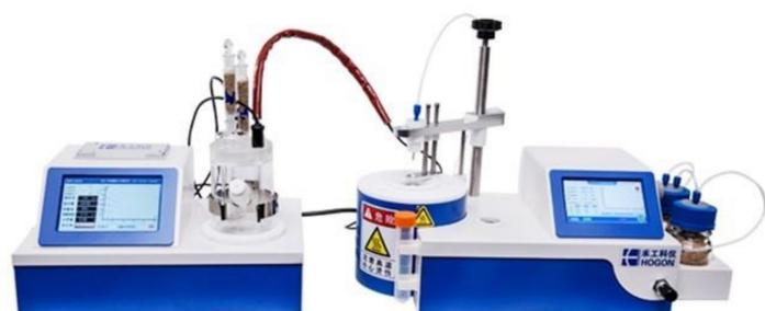
AKF-BT2020C 卡尔费休水分测定仪可以直接将样品加入滴定池快速测定常规液体原料如磷酸铁锂材料、磷酸铁、钴酸锂、锰酸锂、镍酸锂、三元材料等电解液材料的微量水份含量，也可将样品通过配套设备卡氏样品蒸发器，将样品置于密闭的顶空进样瓶中，加热到水的沸点以上，然后借助外接的干燥载气（干燥氮气或空气），将样品瓶中蒸发的水汽带到卡尔费休水分测定仪的滴定池中进行测定
