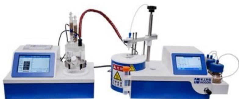
AKF-BT2020C 卡尔费休水分测定仪即可以直接将样品加入滴定池快速测定常规液体原料如磷酸铁锂材料、磷酸铁、钴酸锂、锰酸锂、镍酸锂、三元材料等电解液材料的微量水份含量，也可将样品通过配套设备卡氏样品蒸发器，将样品置于密闭的顶空进样瓶中，加热到水的沸点以上，然后借助外接的干燥载气（干燥氮气或空气），将样品瓶中蒸发的水汽带到卡尔费休水分测定仪的滴定池中进行测定，由于高沸点的物质难于挥发，不会被导入滴定池中，这样滴定池中的卡尔费休试剂就避免了与样品中除水份以外的难溶类物质及其它物质的直接接触，同时避免了其它物质对卡尔费休反应的干扰。经过禾工科学仪器多年的持续改进，带有样品蒸发器的 AKF 系列卡尔费休水滴定仪产品在石墨材料、塑料粒子、润滑油脂、固体药品、橡胶、油品等领域得到了广泛应用机会，积累了丰富的应用经验；并在众多知名企业中获得良好的应用效果。
